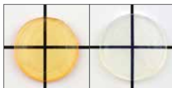
Πρωτότυπο Clear Πάχος τεμαχίου (αμέσως μετά τον πολυμερισμό): 1.0 mm
